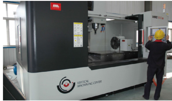
数控立式加工中心：用于精加工叶片，各种叶片模具。
