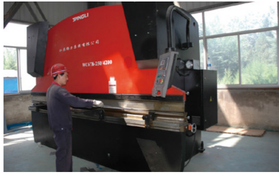
数控折弯机：用于尺寸不同的板材折弯
